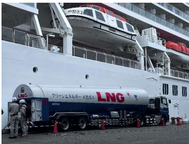
「飛鳥III」横浜港岸壁でのLNG供給 写真 | 郵船クルーズ(株)
