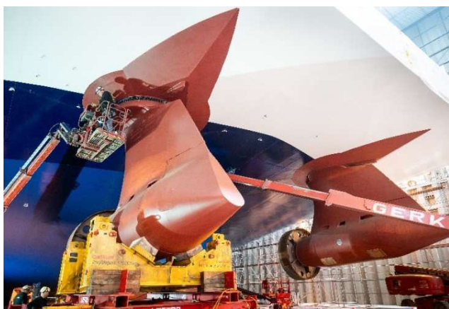
「飛鳥III」POD推進器 写真 | 郵船クルーズ(株)
